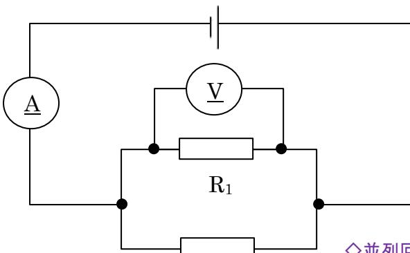
左図で、電流計が示した値は 0.7A、電圧計が示した値は 5V、抵抗器  $R_1$  の抵抗は  $10\Omega$  である。
