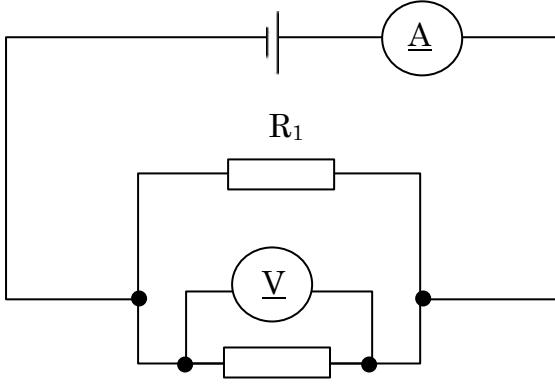
左図で、電圧計が示した値は 6V、抵抗器  $R_1$  の抵抗は  $15\Omega$  である。
