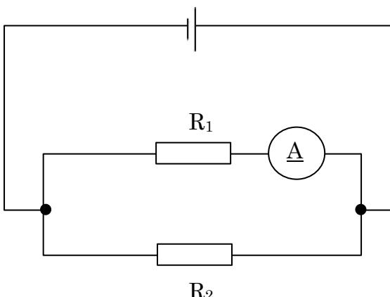
左図で、電流計が示した値は 300mA、抵抗器  $R_2$  の抵抗は  $10\Omega$ 、電源の電圧は 12V である。
